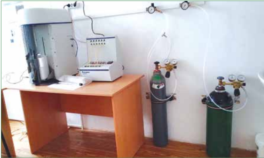
Фигура 3. Система за измерване на повърхност и порьозност TriSTAR II 3020, Micromeritics, дарение от фондация „Александър фон Хумболт“
